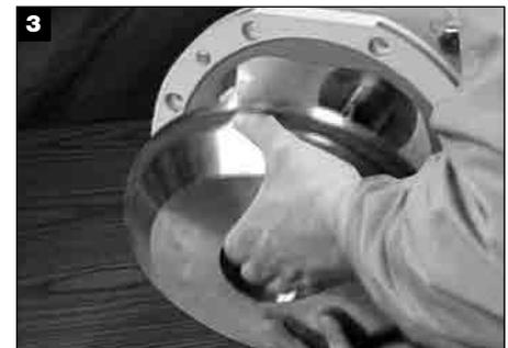
Das Dichtungsgehäuse aus der Anlage ausbauen.
