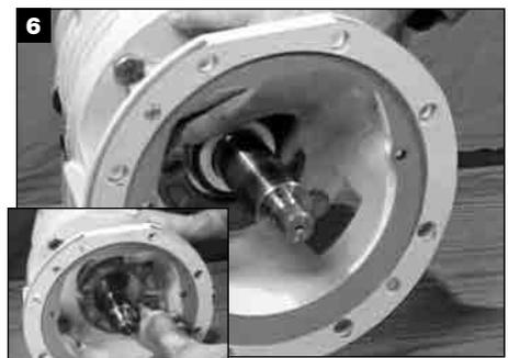
Den Flansch und dann die Gleitringfläche über die Welle schieben. Die Gleitringfläche in den Flansch einpressen, wenn diese mit einem O-Ring montiert wird.
