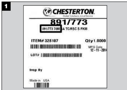
Siehe Etikett für Komponentenennung und Wellendurchmesser. Ermitteln, ob die Rotations-Baugruppe die kurze Ausführung ist (SH = short rotary).
