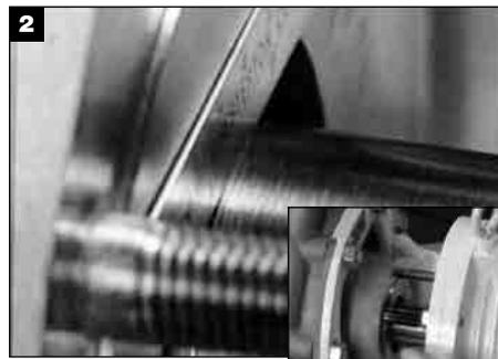
Die Referenzpunkte zur Messung der Einbaumaße aus den Bildern auf Seite 2 ablesen. Die Welle im Bereich mit dem Referenzpunkt mit einer farbigen Kennzeichnungsflüssigkeit besprühen und den Punkt anzeichnen.
