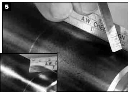
Kennzeichnungsflüssigkeit auf das Ende der Welle sprühen und das Einbaumaß vom Referenzpunkt messen und anzeichnen.
