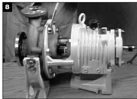
Das Dichtungsgehäuse (hintere Abdeckung) wieder auf der Anlage montieren.
