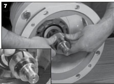
Eine dünne Schicht Schmierfett auf den Wellen-O-Ring auftragen und die Rotations-Baugruppe auf die Welle schieben, bis die hintere Kante mit der gemessenen Markierung abschließt. Alle Feststellschrauben gleichmäßig festziehen.
